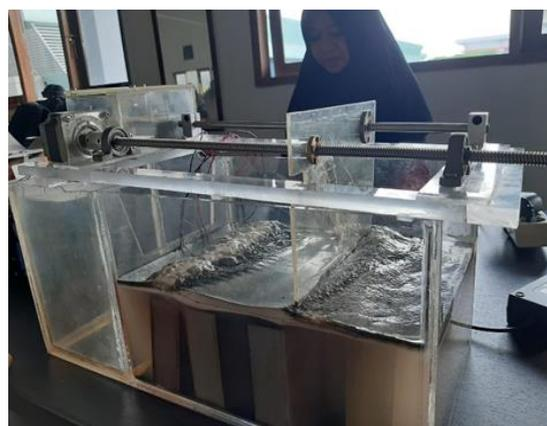
**Gambar 2** Reaktor elektrokoagulan dengan *scraper*
