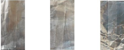
Gambar 1 Lembaran bioplastik pati garut-karagenan dengan konsentrasi pengikat silang (a) \text{CaCl}_2 1% (b) \text{CaCl}_2 2% (c) \text{CaCl}_2 3%.
