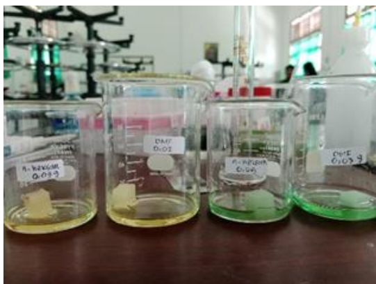
Gambar 1. Uji kemampuan absorpsi spons superhidrofobik.
