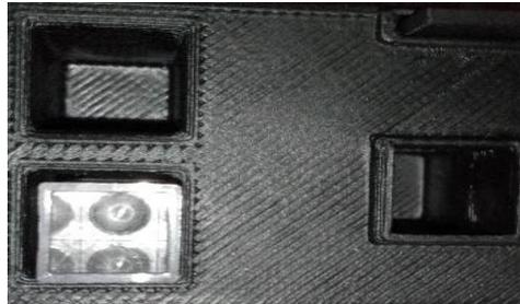
Gambar 4. Kotak kuvet (Cuvette Box)
