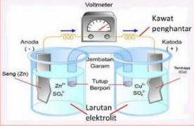
Gambar 1. Rangkaian sel Volta
