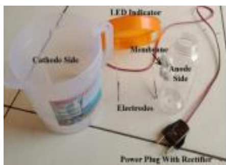
Gambar 6. Peralatan PWMI terdiri dari colokan listrik dengan penyearah, indikator LED, kabel, elektroda, membran, wadah untuk sisi katode dan anode.
