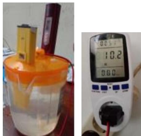
Gambar 7. Teknik pengukuran proses elektrolisis air mineral dengan digital power meter, pH meter dan TDS meter.
