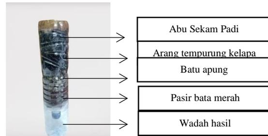
**Gambar 5.** Rangkaian alat TTG skala lab
